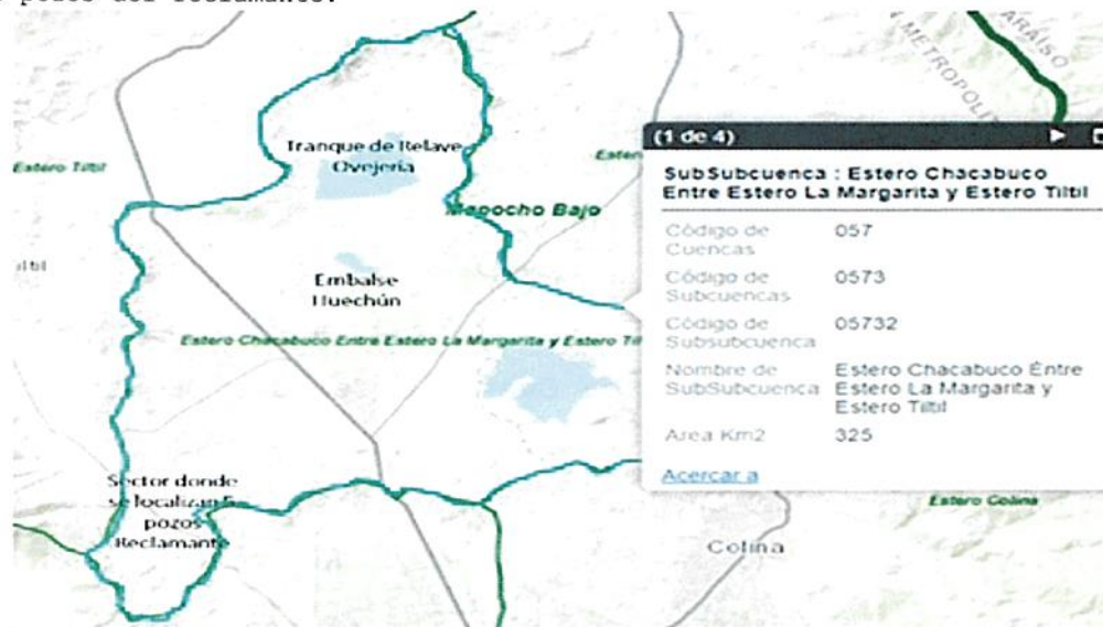
Figura 1: Delimitación de la sub-subcuenca del Estero Chacabuco, donde se localizan en una misma área hidrológica e hidrogeológica el tranque de relaves Ovejería y los cinco pozos del reclamante.
