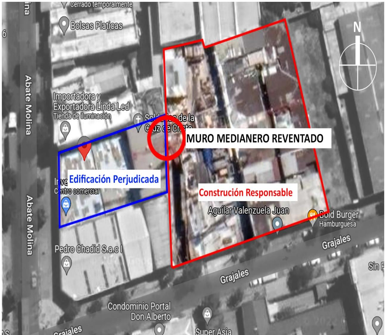
En la siguiente planimetría, se indica el muro Eje 1 entre los ejes A y C. La superficie aproximada de los daños (solo en muro medianero, sin considerar la repercusión en escalera ni recintos aledaños), es de 10 metros de largo por unos 6 metros de altura, con un total de 60 m<sup>2</sup> con daños estructurales y de terminaciones, además de los daños mayores en la estructura de la escalera y revestimientos de baños, camarines y otros recintos interiores.
