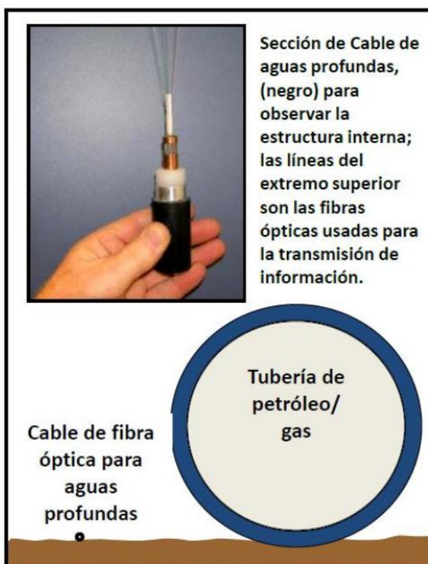
Comparativa de los diámetros de un cable de fibra óptica respecto de una tubería de conducción de petróleo / gas de 600 mm
