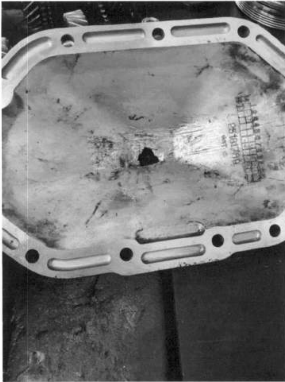
DETALLE QUE MUESTRA EL ROCE INTERIOR EN EL CÁRTER, LO QUE PROVOCÓ SU RUPTURA
