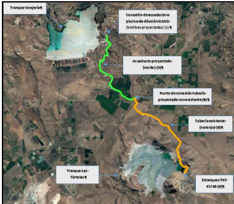
Figura N°3. Trazado del proyecto "Suministro de Aguas Claras desde Embalse Ovejería a Los Bronces vía Acueducto"
