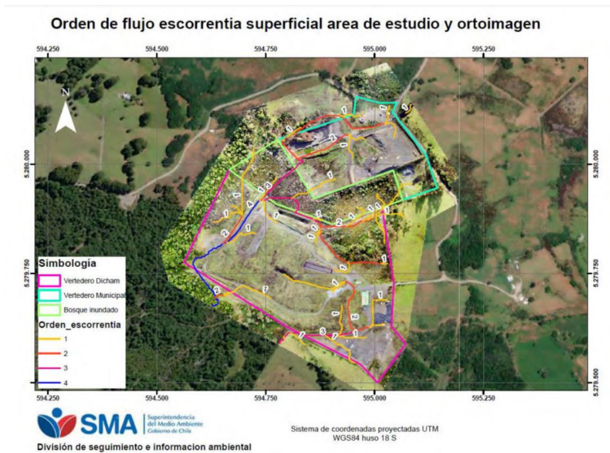
Figura N°21: Escorrentía superficial mediante ortoimagen generada por levantamiento de dron, con resolución de 2 cm/píxel (fs. 6957). Año: 2021. Fuente: Ilustración N°4 de fs. 7708
