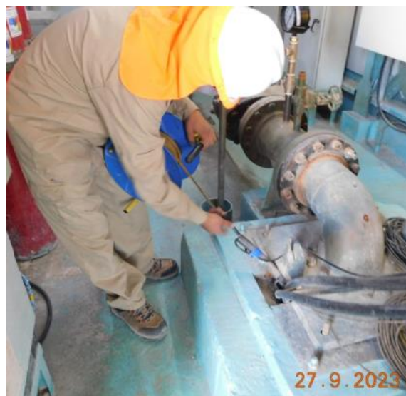
Fotografía N° 10: Medición de nivel dinámico del agua subterránea en pozo P1 (LA-1).
