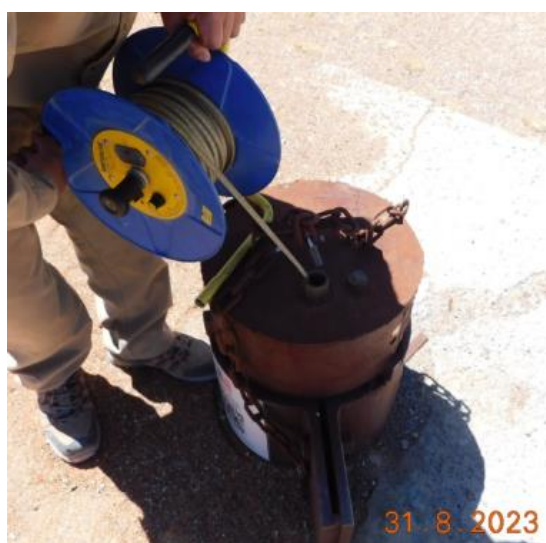
Fotografía N° 5: Medición nivel estático Pozo P2 (LA-2).
